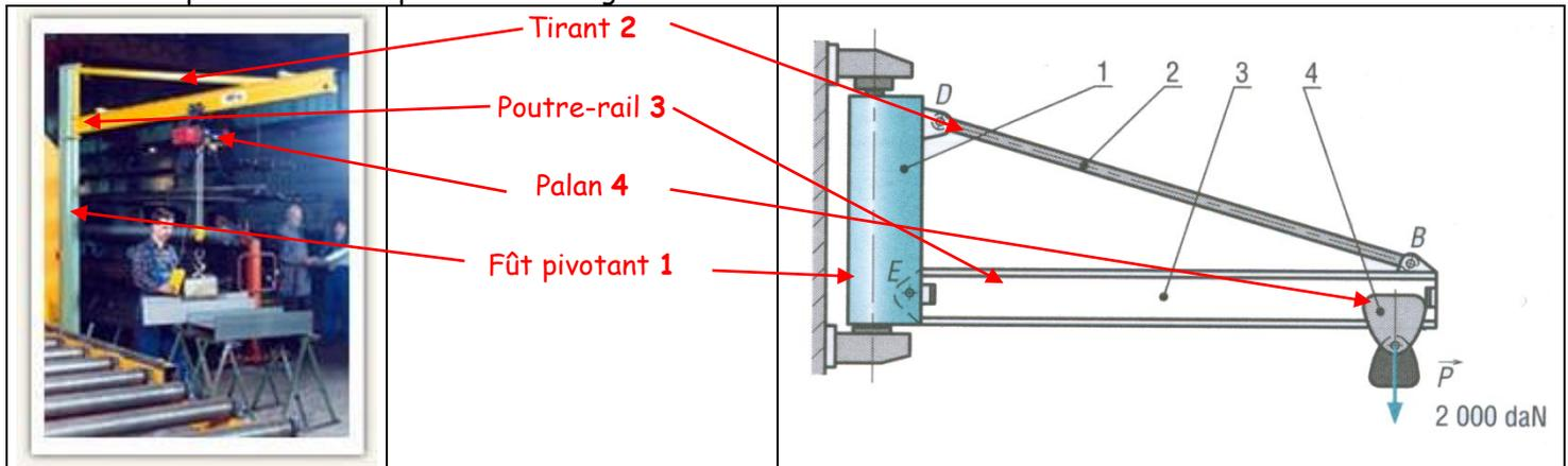
Cette potence se compose d'un palan 4, d'une poutre rail 3, d'un fût pivotant 1 et d'un tirant 2. Le tirant 2 est soumis à une sollicitation de traction : il est soumis à l'action des deux forces  $\vec{B}_{3/2}$  et  $\vec{D}_{2/1}$ , égales et opposées, de direction BD, d'intensité maximale 6 200 N (intensité atteinte lorsque le palan est à l'extrême droite).
